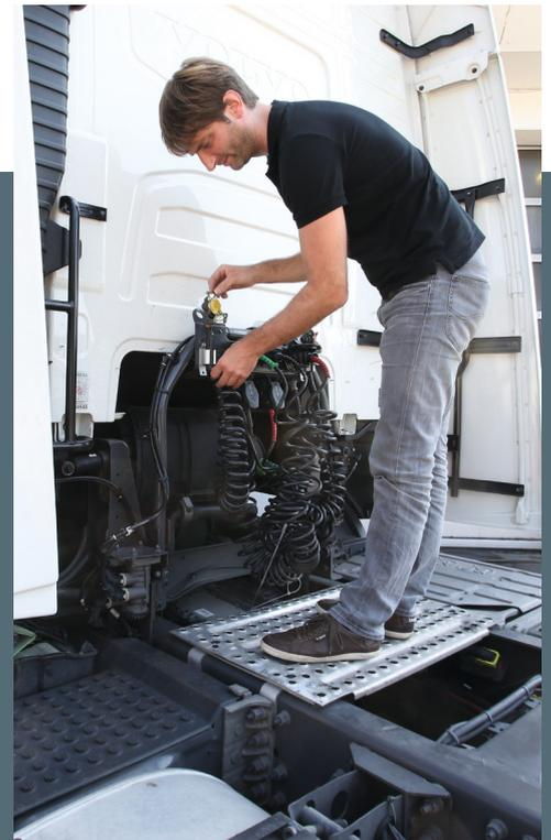
Durchschnittliche Halter für die Bremsschläuche
